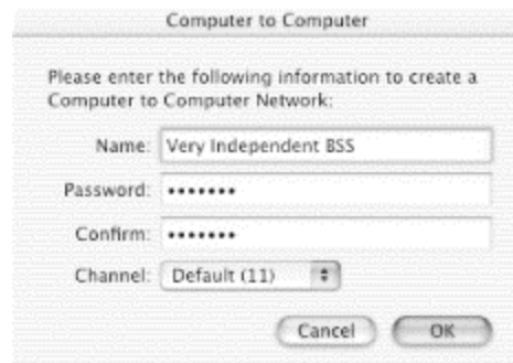
Figure B-5. IBSS parameter setup
